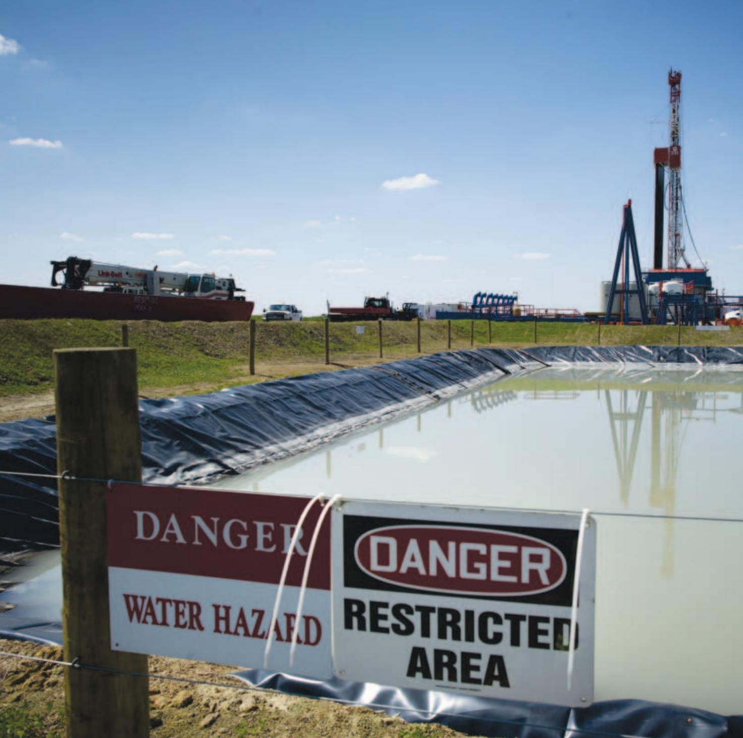
Lagoa de depósito de resíduos do fraturamento hidráulico do Gás de Xisto.
